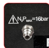
Test szczelności z azotem
