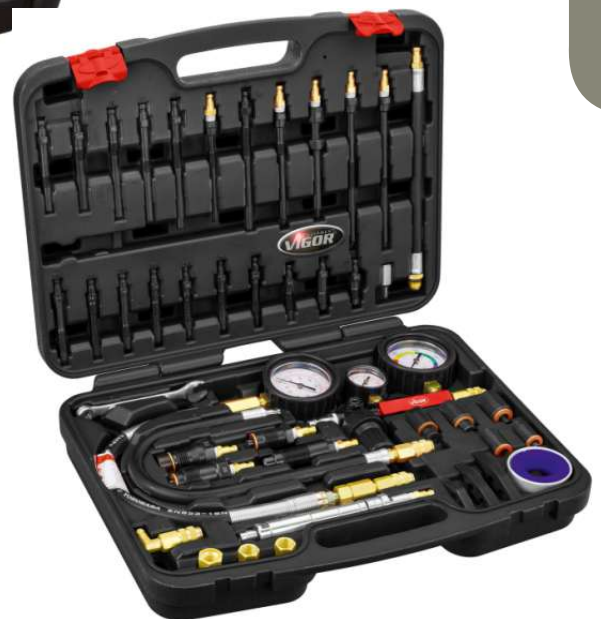
Art. V4461 Zestaw do testowania kompresji i utraty ciśnienia - VIGOR – V4461. 48 narzędzi do silników wysokoprężnych i benzynowych Zawiera: - adaptery świec żarowych i świec zapłonowych oraz szybkozłączki proste i zagięte - adaptery dysz wtryskowych - Urządzenie do kontroli ciśnienia kompresji, max. 50 barów
